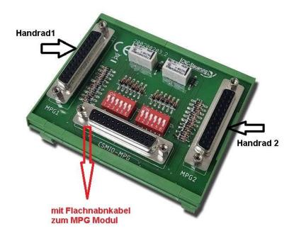
Das Modul erkennt automatisch welches Handrad gerade die Bewegung ausführen soll. Durch das Drücken der Zustimm Taste schaltet das Modul die Signale um.
