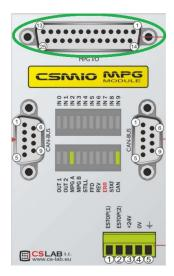
Das Flachbandkabel (grüner Kreis) wird am MPG-Modul hier aufgesteckt.
