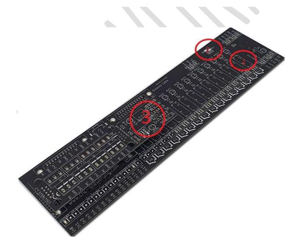
Achtung dieses Aufsteckmodul arbeitet nur mit der IP-S IN OUT-Board zusammen an dem Sie oben (2) den Jumper haben. Wer diesen Jumper nicht hat, muss auf die Hutschienenvariante ausweichen. Der Ausgang an unserem Relais ist mit 230 Volt 6 Ampere belastbar.
